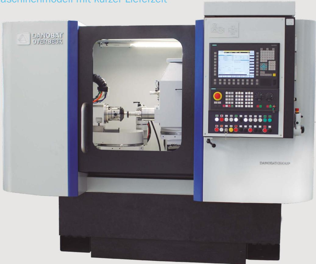
Die Maschinen IRD-400 S eignen sich ideal für das hochgenaue Innen-, Außen-, Plan-, Unrund- und Radiusschleifen von Werkstücken aus verschiedensten Materialien.
