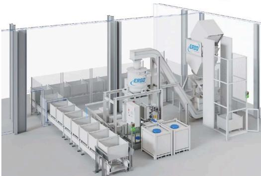
**Automatisiertes Spänehandling:** Vollautomatische Komplettanlagen mit Späneförderern, Zerkleinerungstechnik, Brikettieranlagen und Spänezentrifugen. Späne werden mittels Absauganlage direkt am Späneförderer Ihrer CNC-Maschine erfasst.
