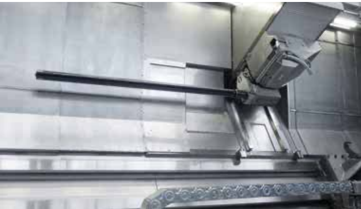
Tieflochbohren mit automatischer Kühlmittellandockung
