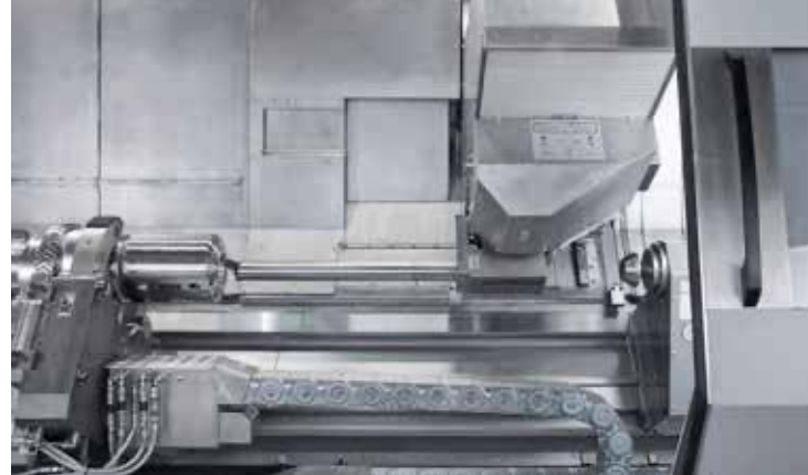
Innenbearbeitung mit gedämpfter Bohrstange
