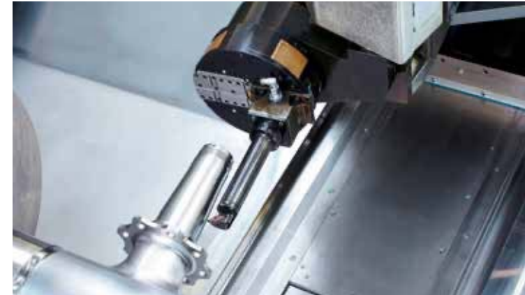
CNC-Plandrehkopf für komplexe Spindeloperationen
