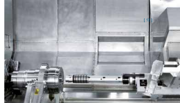
CNC-Konturbohrstange (radiale Aussteuerung mittels U-Achse)
